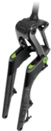
fourches télescopiques présentent des défauts bien connus tels le phénomène de plongée au freinage, une rigidité limitée en torsion, l'usure des plongeurs, une faible sensibilité sur les petits chocs et une nécessité d'entretien courant.
